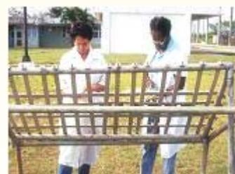
Fig.1 - Evaluación en estación de corrosión rural ISO 9223 = C3
